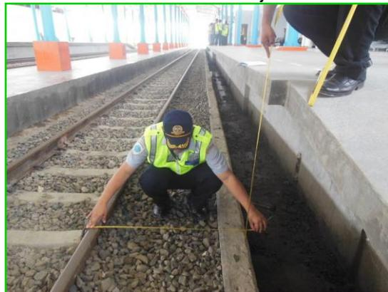
**Pengukuran Jarak Jarak tepi peron ke as rel di Stasiun Ngrombo**
