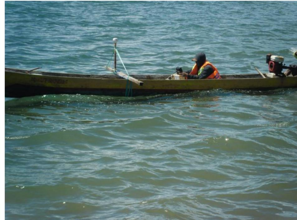
Gambar 26 Survey Bathymetri di Pelabuhan Laut Kobisadar
